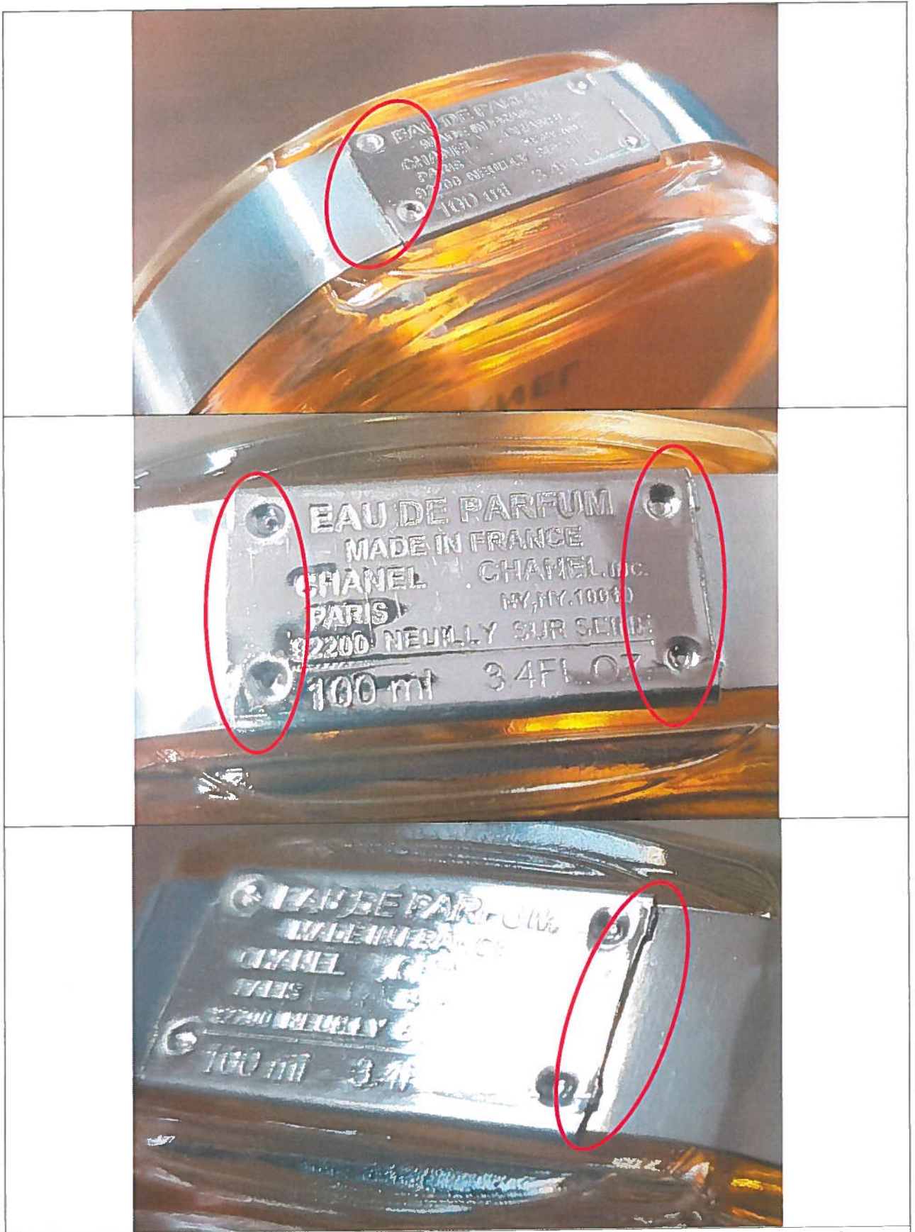
Деформированная металлическая пластина, с неровностями; Некачественный оттиск шрифта
