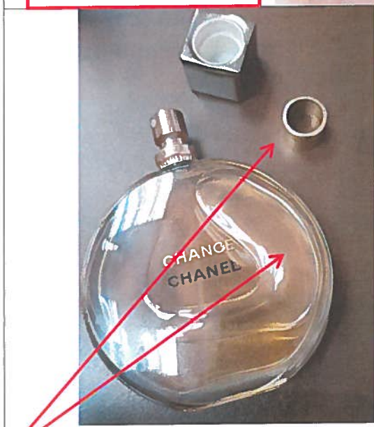
Отпавший распылитель; Неравномерность стекла флакона
